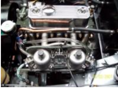
Inbouw van de 1275 cc motor
